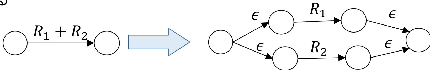
左は、 $L(R_1 + R_2) = L(R_1) \cup L(R_2)$ に入る文字列を読むと遷移
